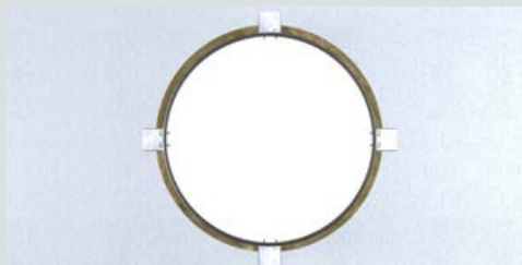
Varje vinkeljärn fästes i taket/golvet med två 6,5 x 51 mm skruvar
