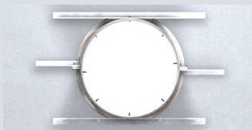
Fäst kanalsvepet i kanalen med skruvar 4,8x25mm.
